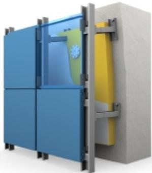
Еще один способ теплоизоляции фасадов - наружное утепление с вентилируемой воздушной прослойкой, которая располагается между облицовкой и утеплителем и удаляет влагу, испаряющуюся из помещения, при помощи восходящего потока воздуха.
